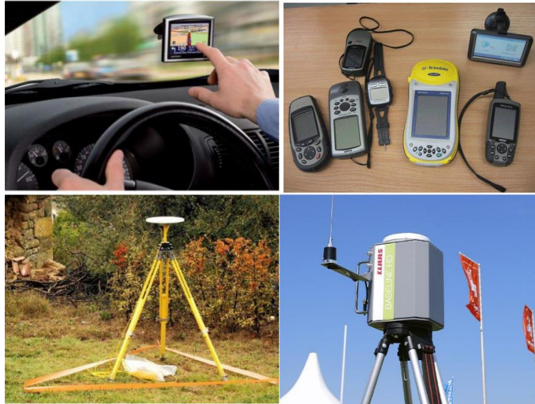
Fig. 21. Receptoare GPS: navigație auto, dispozitive de cartare (mod absolut și diferențial), receptoare geodezice, stații de referință
